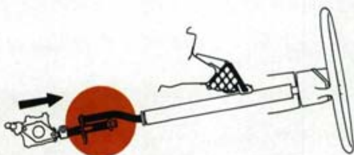
Die Sicherheitslenksäule beim Passat
