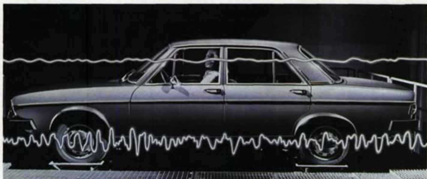
Der Audi 100 auf der Hydropuls-Anlage
