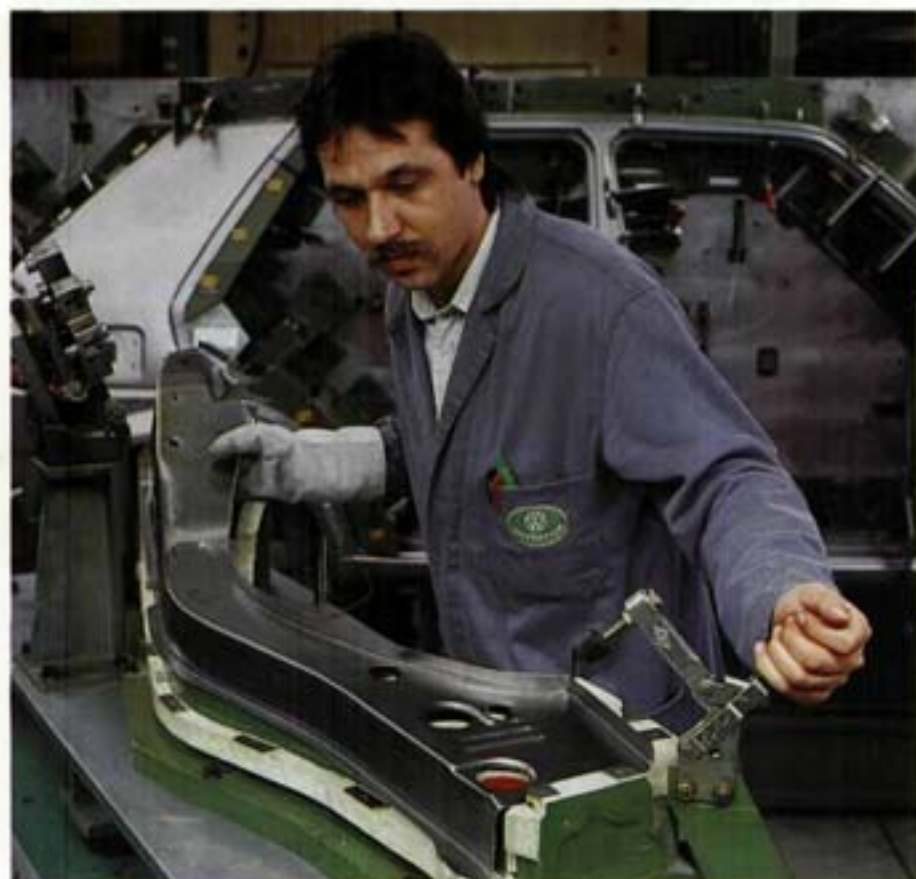
Überprüfung von Serienteilen auf Maßgenauigkeit mittels Lehren
