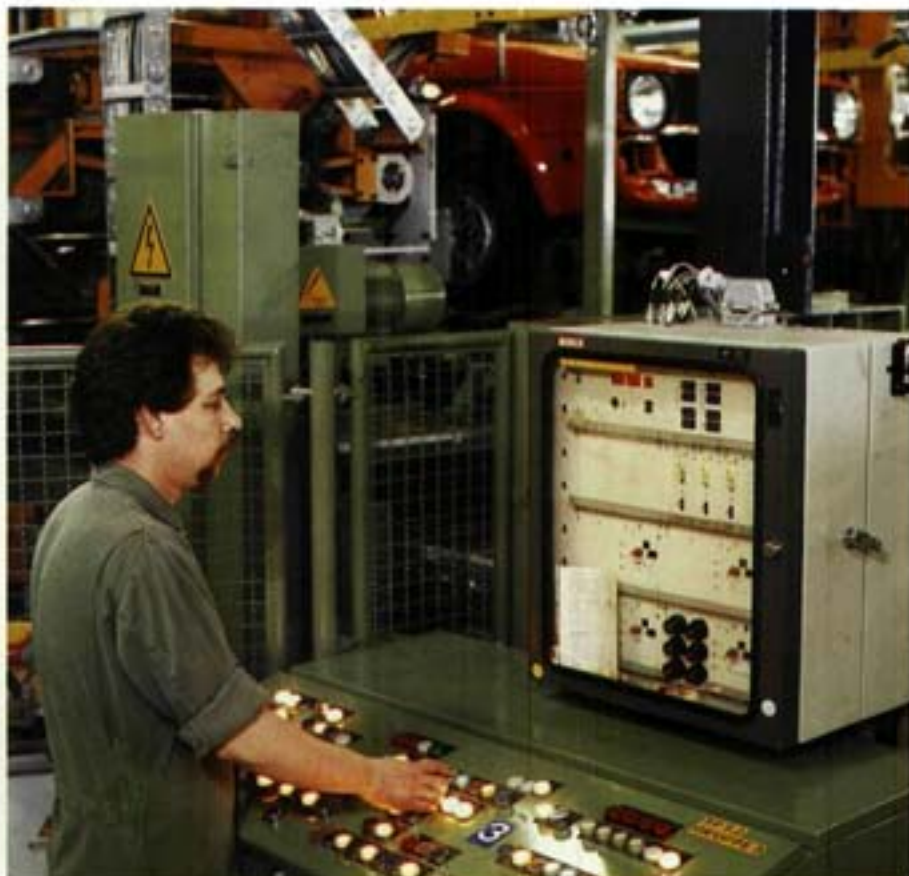
Vollautomatische Überprüfung von Drehmoment und -winkel von Radmuttern
