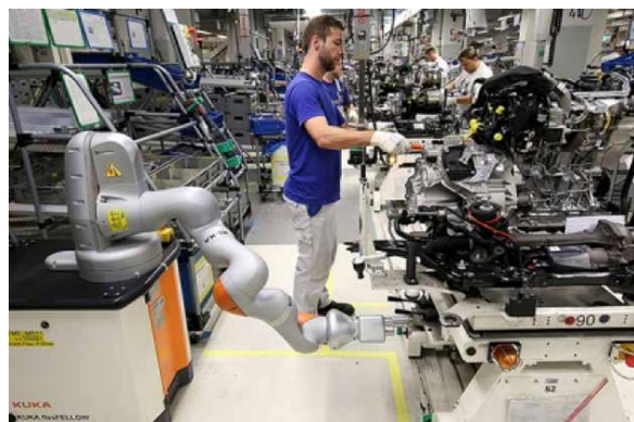
Der Roboter entlastet den Menschen bei ergonomisch ungünstigen Tätigkeiten
