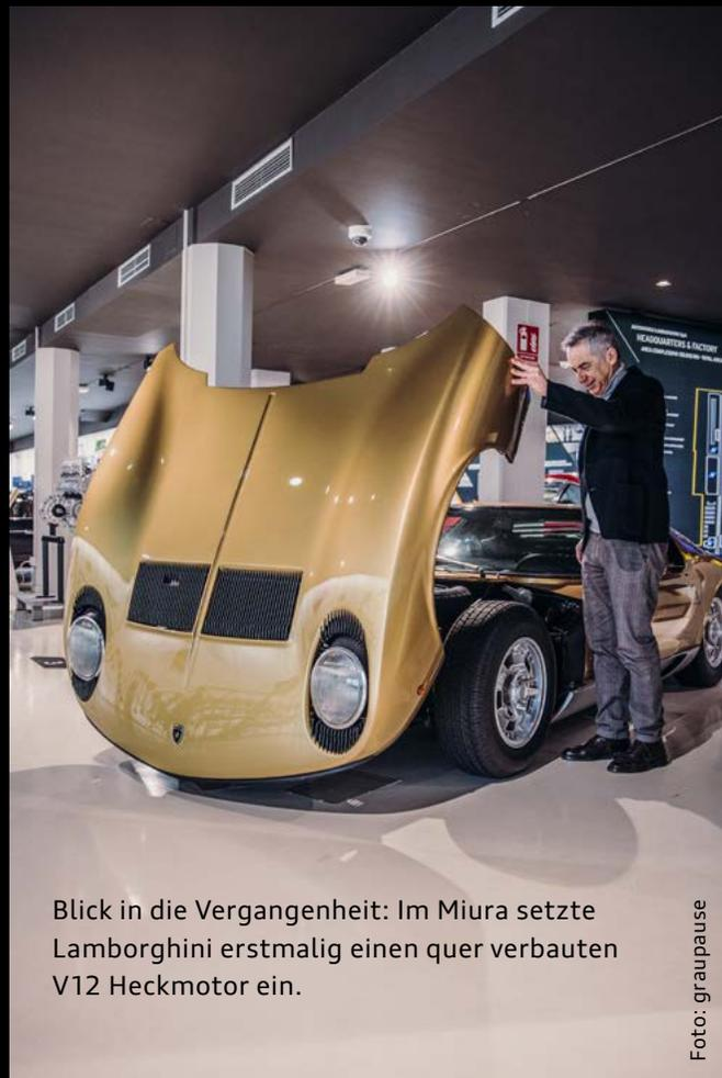
Blick in die Vergangenheit: Im Miura setzte Lamborghini erstmalig einen quer verbauten V12 Heckmotor ein.
