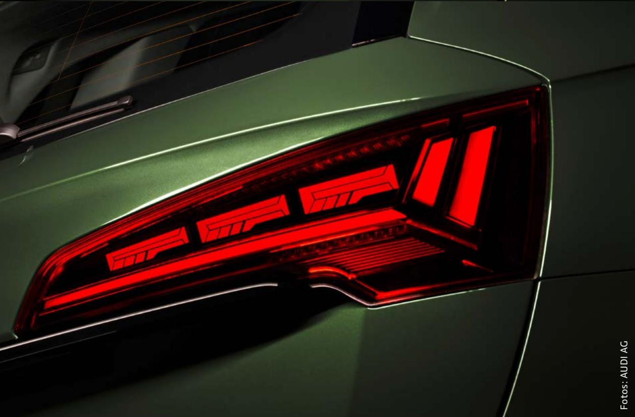
In einer Rückleuchte des Audi Q5 kommen drei Panels zum Einsatz, die jeweils sechs OLED-Segmente integrieren. Diese sind nun beliebig aktivierbar und stufenlos in der Helligkeit regelbar. Unten zu sehen ist die optionale Annäherungserkennung durch Aktivierung aller OLED-Segmente.
