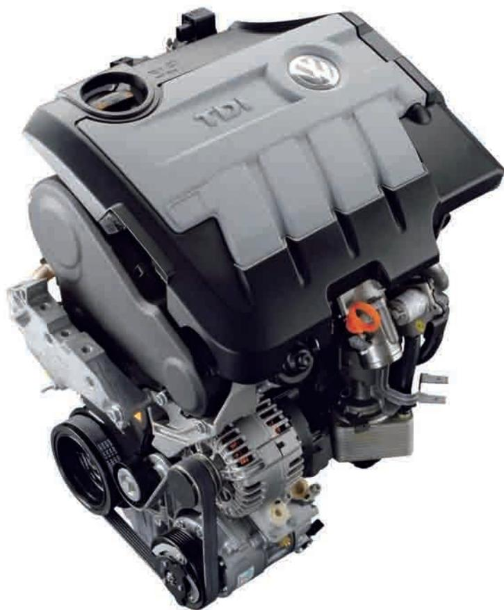
inyección directa consume tan sólo 6,9 l/100 km (160 g/km CO<sub>2</sub>), entrega un par máximo de 280 newtonmetros a partir de 1.800 r.p.m., acelera de 0 a 100 km/h en tan sólo 7,5 segundos y alcanza una velocidad máxima de 236 km/h. Este motor puede combinarse también opcionalmente con el cambio automático 'DSG' de 6 velocidades adaptado a su gran rendimiento.
